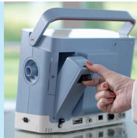
Batería desmontable de sustitución rápida para brindar una autonomía constante.
