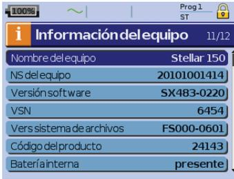
Esta pantalla muestra el número de serie (que aparece como NS del equipo), la versión de software y otras versiones de los componentes. Los datos de esta pantalla pueden ser solicitados por un técnico para dar mantenimiento o como parte de la solución de problemas.
