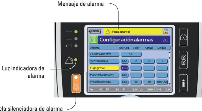
Los mensajes de alarma se muestran a lo largo de la parte superior de la pantalla. Las alarmas de alta prioridad se indican en **rojo**, las de prioridad media en **amarillo** y las de prioridad baja en **azul claro**. Las luces indicadoras de alarma se iluminan en **rojo** durante las alarmas de alta prioridad y en **amarillo** durante las alarmas de prioridad media y baja.
