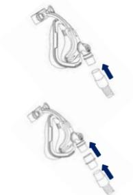
Conecte el tubo de aire principal directamente o a través de la junta giratoria auxiliar opcional que facilita la desconexión. Luego, conecte el extremo libre del tubo de aire al generador de aire y encienda el generador de aire.
