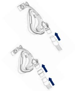
Conecte el tubo de aire principal directamente o a través de la junta giratoria auxiliar opcional para facilitar la separación.
