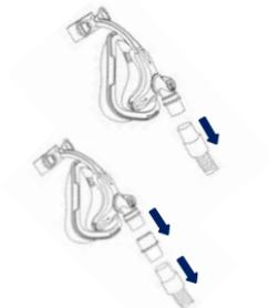
Desconecte el tubo de aire o la junta giratoria auxiliar opcional.
